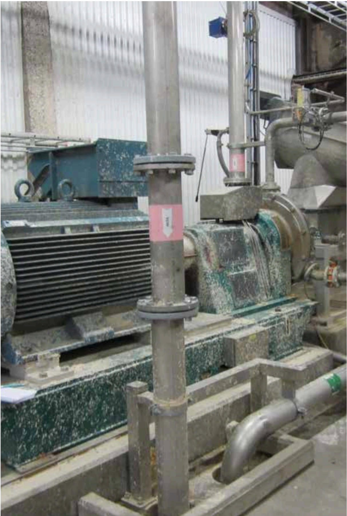
Den nyinstallerade Krima-dispersern används för bearbetning av våtstarkt utskott och lagrad smulmassa.
