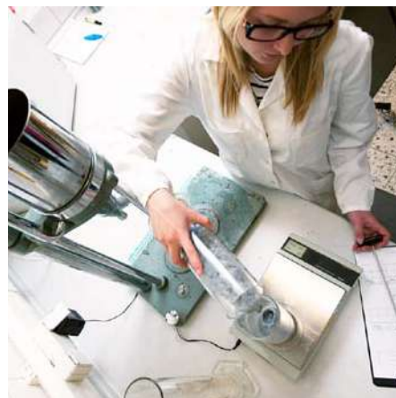
纤维悬浮液和纸样抄片在我们的实验室进行
