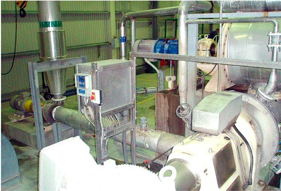
Grubbens中浓泵设计直接用于Krima热分散机的出口增压卸料，这两个设备组成一套中浓卸料的独特解决方案。
